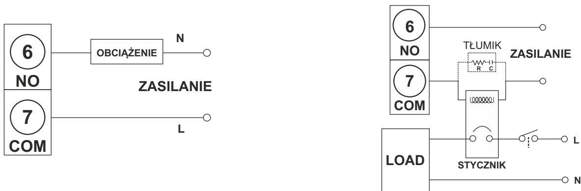
Rys2. Wyjście główne/sterujące— Przekątnik/SSR do sterowania stycznikiem (dla jednej fazy)
